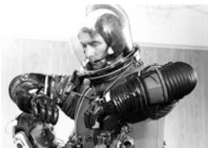
Figura 8-21. Gene Cernan verifica la taglia dello strato ermetico della tuta spaziale, il Pressure Garment. Si notano le articolazioni a soffietto anche sulle dita. Foto NASA AP17-72-H-253.
