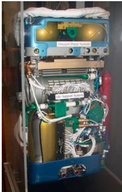
Figura 8-10. L'interno di uno zaino delle tute spaziali Apollo. Credit: Ulli Lotzmann/NASM.
