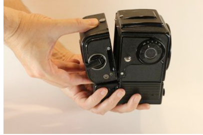
Figura 8-6. Innesto di un caricatore sul corpo di una fotocamera Hasselblad EL/M simile a quelle usate sulla Luna. I caricatori lunari erano più grandi di quello mostrato. Credit: PA.
