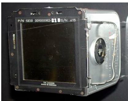
Figura 8-9. Il caricatore R della missione Apollo 11, oggi esposto al National Air and Space Museum di Washington, D.C. Si noti l'anello maggiorato per estrarre la darkslide con i guanti della tuta spaziale. Credit: NASM.
