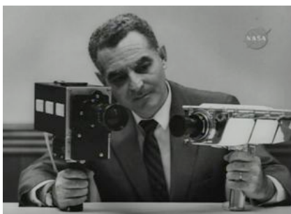
Figura 6-5. Stan Lebar, capo del progetto delle telecamere Apollo della Westinghouse, mostra la telecamera per interni (a sinistra) e quella lunare dell'Apollo 11 (a destra).
