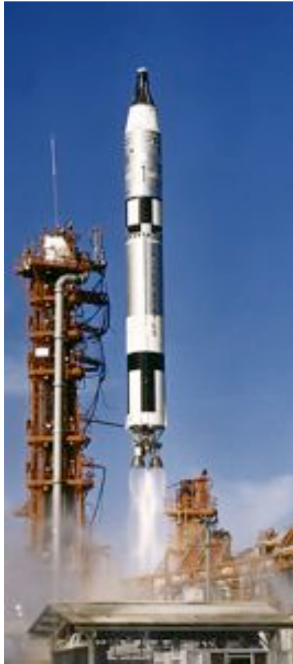
Figura 6-25. Decollo del vettore Titan che porta la capsula Gemini 12, 11 novembre 1966. Si notano lo scarico dei motori pressoché incolore e l'assenza di fiamme.
