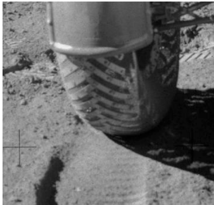
Figura 5-62. Dettaglio della foto AS16-108-17620. Si notano la scarsa scolpitura del terreno e la trasparenza del battistrada (rivelata dall'ombra).
