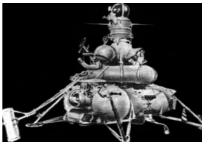
Figura 3-18. Una sonda sovietica della serie Luna, attrezzata per raccogliere campioni di suolo lunare.
