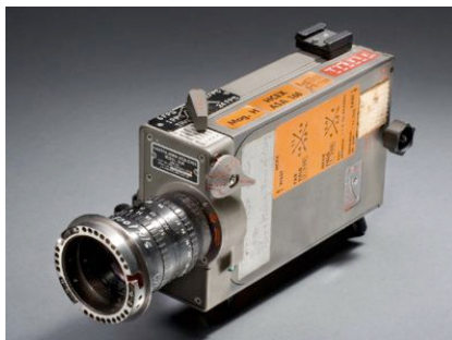
Figura 6-2. La cinepresa Maurer 16mm usata a bordo del modulo di comando dell'Apollo 11. Fonte: Smithsonian National Air and Space Museum.
