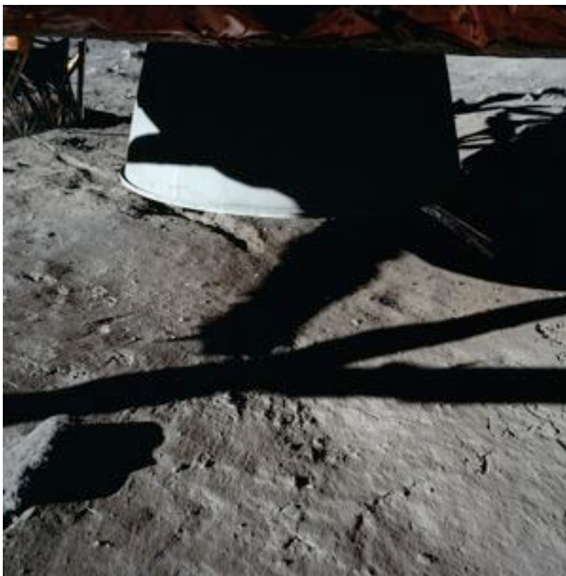
Figura 8-13. L'ugello del motore di discesa del modulo lunare dell'Apollo 11. Si notano in primo piano la superficie rocciosa liscia e priva di polvere e i segni a raggiera prodotti dal getto del motore. Foto AS11-40-5921.
