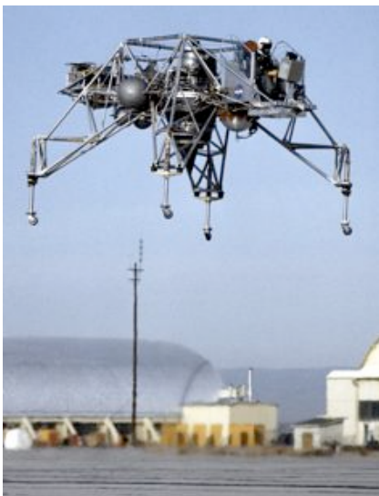
Figura 7-17. Un LLRV in volo nel 1964. Dettaglio della foto NASA ECN-506.
