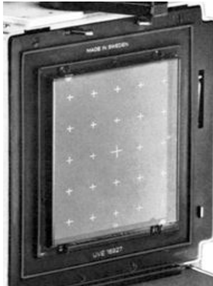
Figura 5-36. Le crocette di riferimento sul vetrino di una fotocamera Hasselblad.
