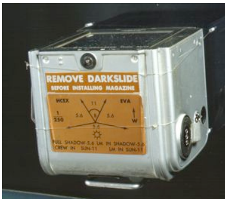
Figura 5-2. Un caricatore di pellicola usato per la missione Apollo 11. Si nota l'adesivo recante le promemoria delle regolazioni per le varie condizioni di luce.
