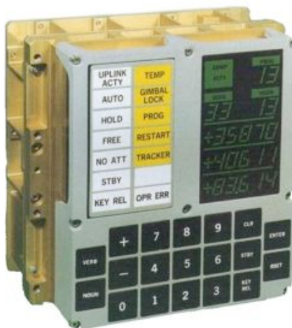
Figura 7-3. Lo schermo e la tastiera di un Apollo Guidance Computer (AGC).
