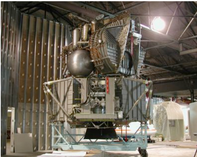
Figura 7-22. Un prototipo del modulo lunare, custodito presso lo Smithsonian National Air and Space Museum, rivela la struttura metallica al di sotto del rivestimento termico. Credit: NASM, www.nasm.si.edu .
