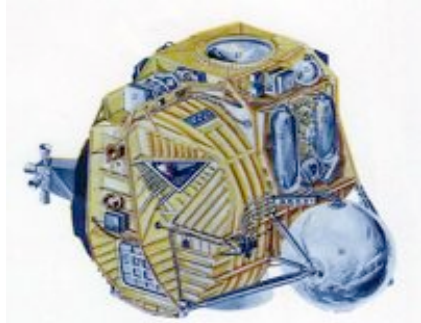
Figura 7-13. Spaccato dello stadio di risalita del modulo lunare, tratto dalla documentazione Grumman.
