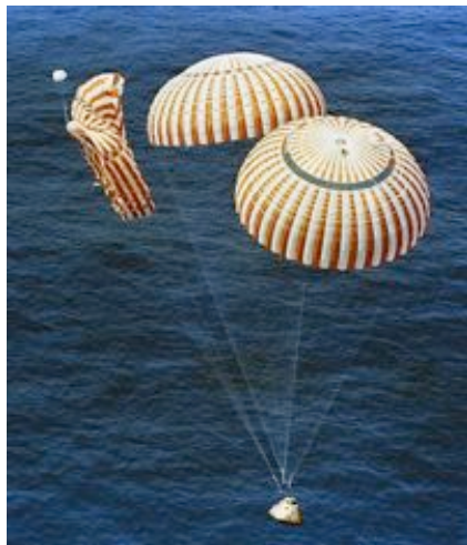
Figura 7-4. L'ammarraggio dell'Apollo 15 con un paracadute difettoso. Dettaglio della foto AS15-S71-42217.
